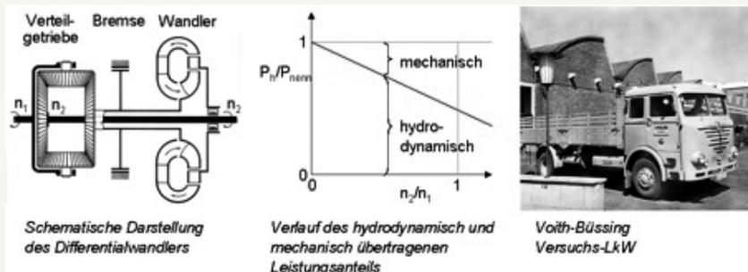
Abbildung 6: Hydrodynamisches Getriebe mit Differentialwandler, Voith DIWA Bus Getriebe
