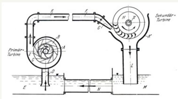
Abb. 6: Kopplung von getrennter Pumpe („Primärturbine“) und Turbine („Sekundärturbine“) über externe Leitung [9]
