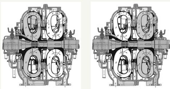
*Abb. 6: Ursprünglicher Föttinger-Transformator für Vor- und Rückwärtsfahrt*
