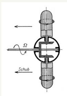
Abb. 11: Föttingers Idee eines Propellers mit Magnus-Rotoren.
