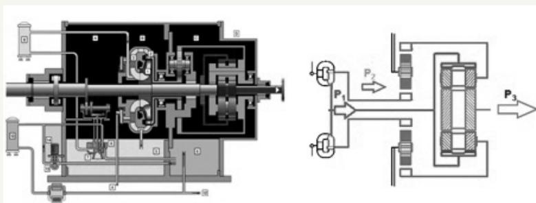
Abbildung 12: Voith Überlagerungsgetriebe (Vorecon®), ab 1985
