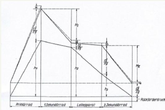
Abb. 11: Druckverlauf im zweistufigen Föttinger-Wandler [10].
