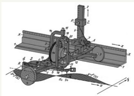
*Abb. 8: Von Föttinger entwickelter Vektorintegrator zur Darstellung von Strömungen aus beliebigen Quellen-Senkenverteilungen. Zweifellos hat dabei der allen älteren Schiffbauern bekannte Integrator, entwickelt von dem Schweizer Prof. Amsler-Laffon (1823 - 1911), zur Ermittlung der Stabilitätsquerkurven, der sog. Pantokarenen, Pate gestanden.*
