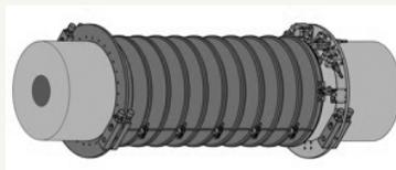
Abb. 3: Moderne Messeinrichtung der Torsion von Schiffswellen, entwickelt am Institut für Schiffbau in Hamburg um 2000<sup>5</sup>.
