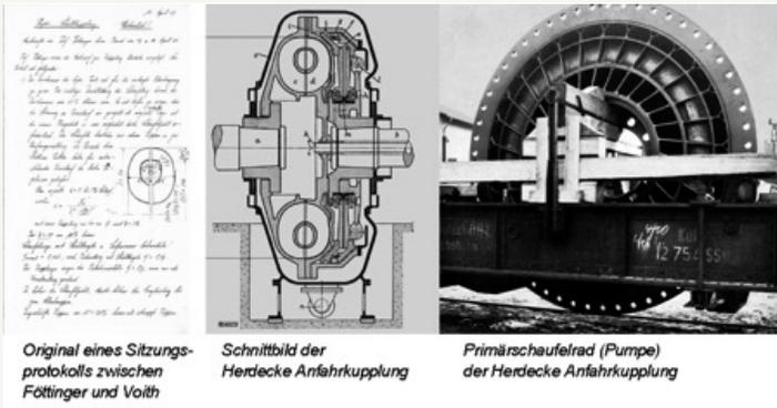
Abbildung 5: Entwicklung der Föttinger-Voith Anfahrkupplung für das Pumpspeicherkraftwerk Herdecke
