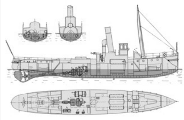
Abb. 5: Versuchsschiff FÖTTINGER TRANSFORMATOR, gebaut vom Stettiner Vulcan 1905.
