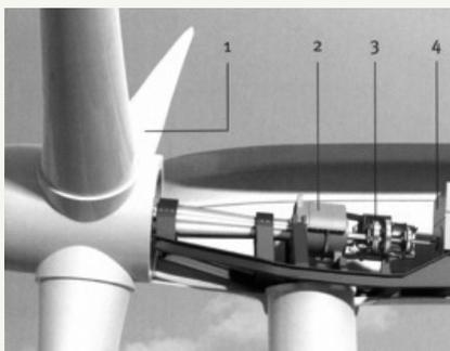
*Abb. 7: Moderne Windenergieanlage. 1 Rotor, 2 Hauptgetriebe, 3 regelbares Überlagerungsgetriebe WinDrive der Firma Voith<sup>8</sup> mit einem Föttingergetriebe, das die wechselnden Drehzahlen des Rotors mit dem Synchrongenerator 4, der mit einer festen Drehzahl betrieben wird, koppelt.*
