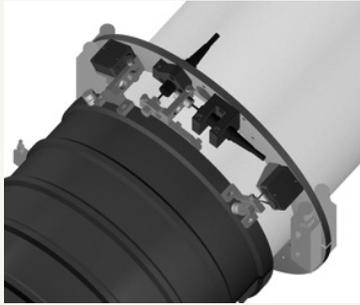
*Abb. 4: Die geistvolle mechanische Messvorrichtung von Föttinger ist nach 100 Jahren eigentlich nur durch einfache Laser - Elektronik - Technik ersetzt worden. Das Prinzip ist dasselbe geblieben.*
