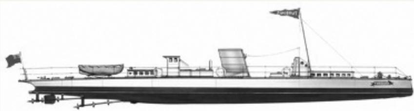
*Abb. 4: Die Turbinia von Charles Parsons, 30,5 m -Yacht, 1894 abgeliefert, 1896 umgebaut, 1897 bei Spithead demonstriert. Erstes Schiff mit Dampfturbinenantrieb.  $\Delta = 44,5$  tons, drei Wellen, max. 2000 HP, 34,5 Knoten [5].*
