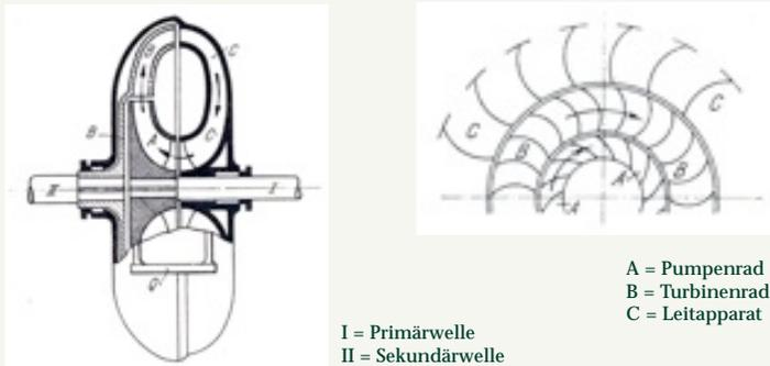
Abb. 7: Das Grundsche ma: Direkte Kopplung von Pumpen- und Turbinenrad [4, S.170]
