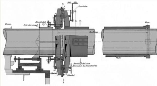
Abb. 2: Ursprünglicher Torsionsindikator von Hermann Föttinger, entwickelt um 1900 in Stettin.
