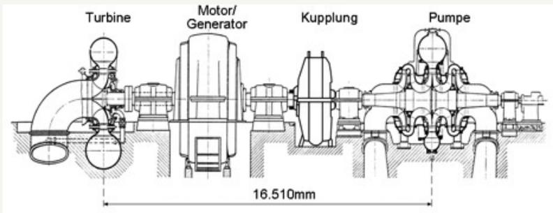
Abbildung 4: Maschinensatz des Pumpspeicherkraftwerk Herdecke
