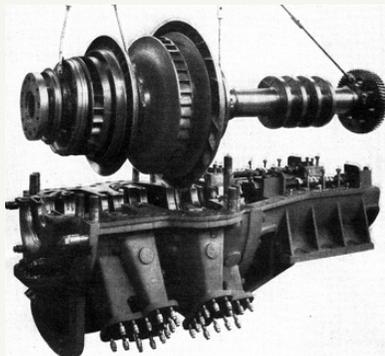
Abb. 10: Geöffneter Drehmomentwandler mit VW- und RW-Teil auf Sekundärwelle [10]
