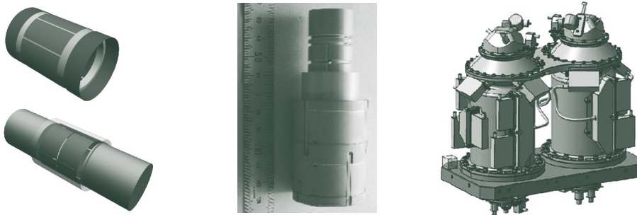
Abbildung 2: Design der zylinderförmigen Testmassen (links) und schematische Darstellung des T-Sage (rechts).
