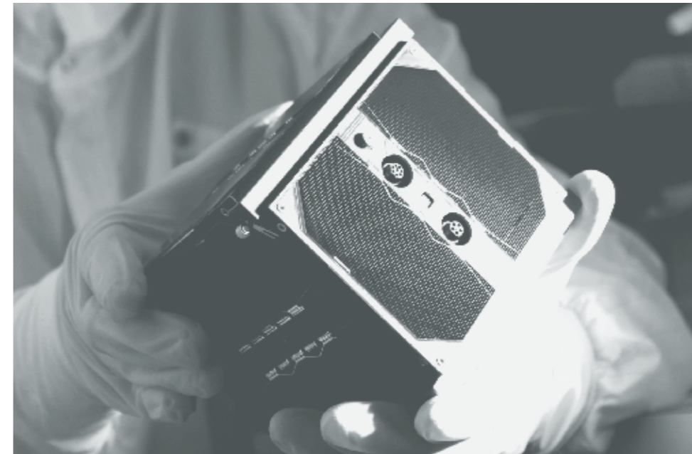
Abbildung 1: Das Flugmodell des Würzburger Pico-Satelliten UWE-3 wurde 2013 gestartet und wird seit über zwei Jahren erfolgreich im Orbit betrieben. Dort demonstriert der Satellit unter anderem neue Technologieansätze zur effizienten Lageregelung. UWE-3 dient als Technologiedemonstrator einer zukünftigen Formation kooperierender Kleinstsatelliten.
